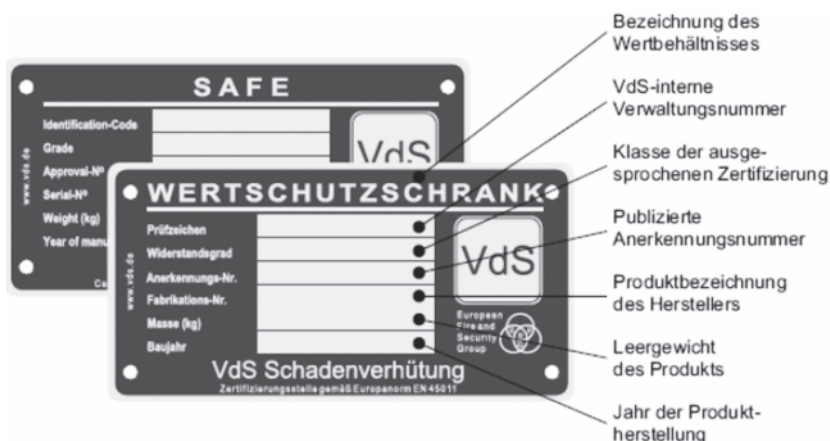
Beispiel VdS-Prüfplakette Die Prüfplakette eines Wertschutzschranke ist auf der Innenseite der Tür angebracht.
